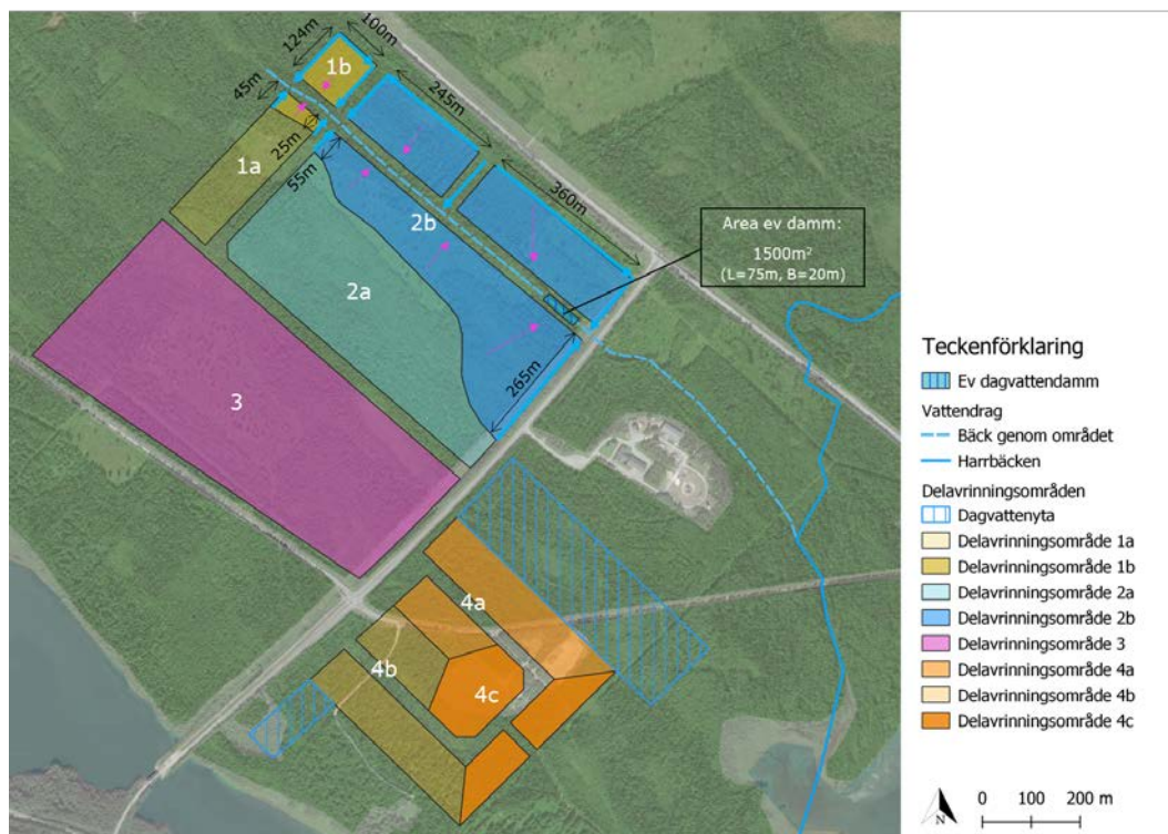
Figur 2. Planområdet uppdelat i delavrinningsområden samt förslag till dagvattenlösningar, här rening i diken med flödes hinder längs med tomtmarken samt dagvattendamm i slutet av systemet.
